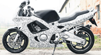
Hydrografika se hodí jak na malé díly, tak i na velké plochy. Je to revoluce v oblasti „lakování“
